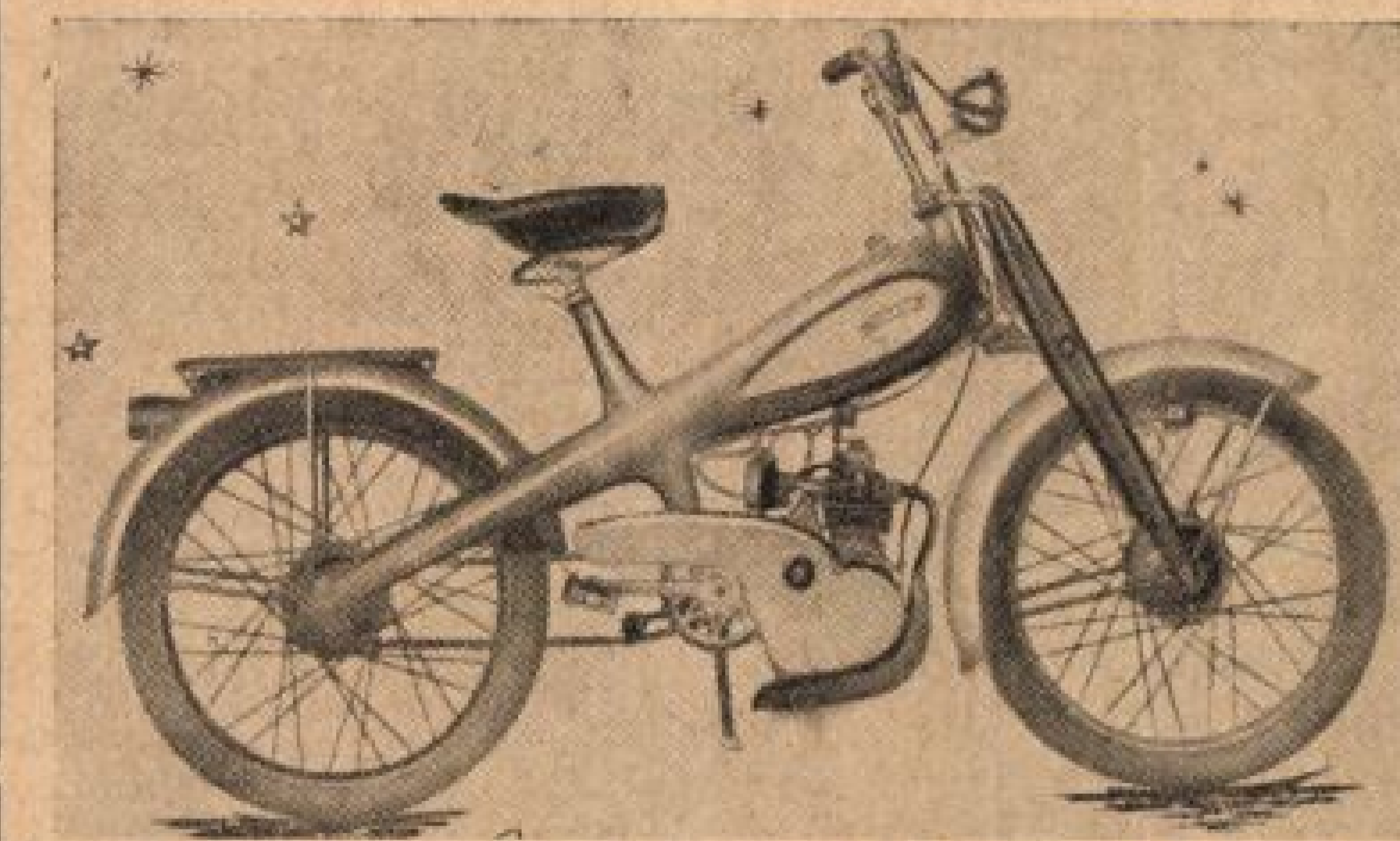
Most jelent meg az olasz piacon a CICLO-MOTOM 43, az olasz népmotor. A motor 40—45 kilométeres sebességgel megy, 75 kilométerre 1 liter benzint fogyaszt. A motor 4 ütemű, 48 km-es, 3 sebességű, teljes súlya 35 kg.
