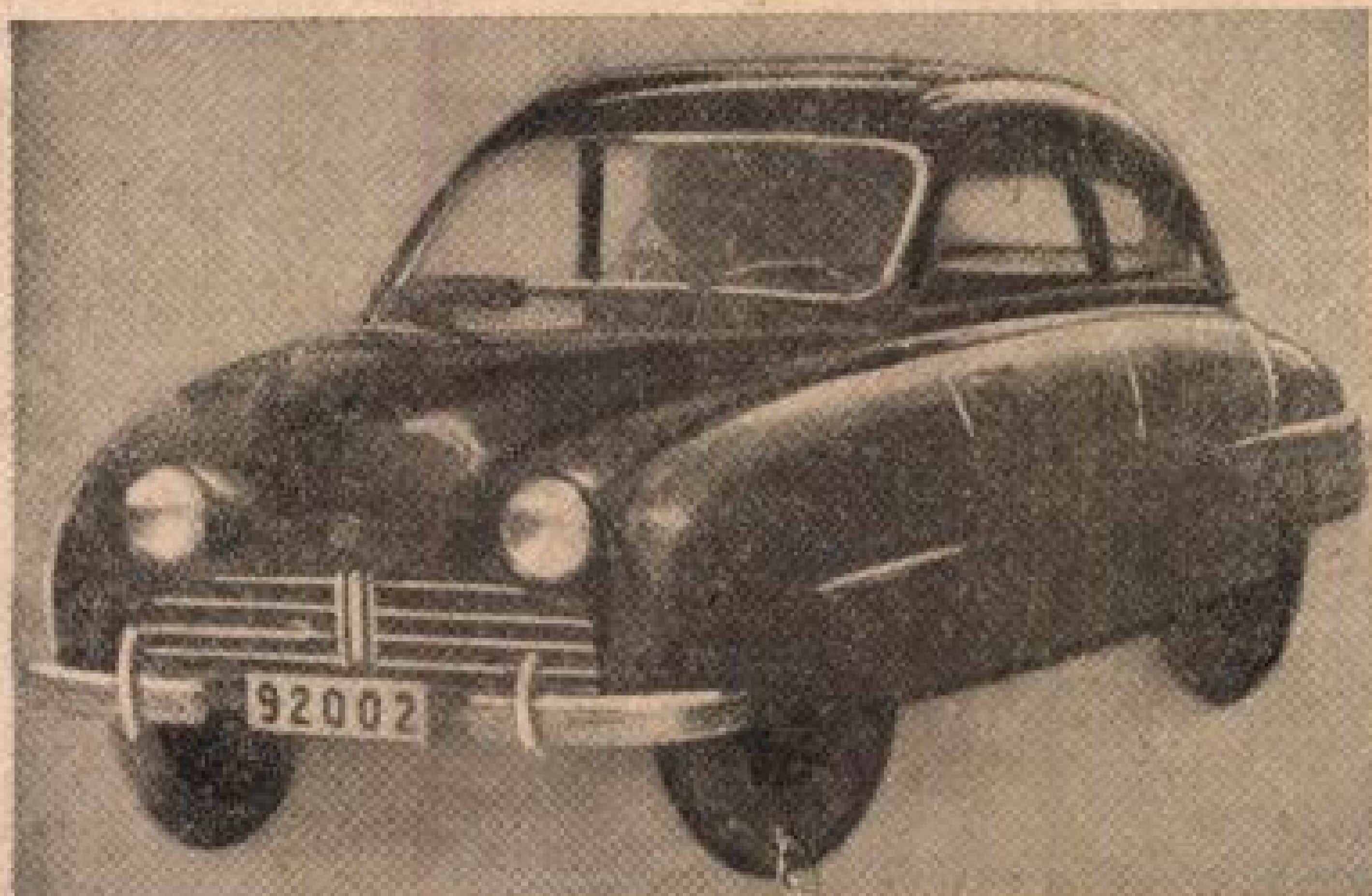
Megindult a svéd autógyártás. A Svéd Repülőgépgyár Rt. 2 hengeres 2 ütemű autóval jött ki. A kocsinak nincs külön alváza, nyomtáva 2.47 m. és elől-hátul torziós rugózású.
